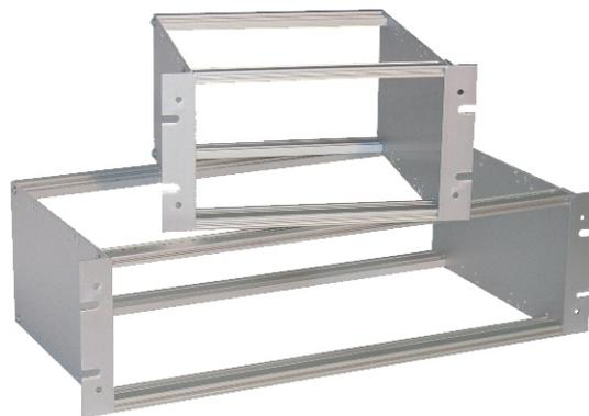
**Baugruppenträger BGT sind Basiseinheiten der 19-Zoll-Gehäusetechnik. Sie bestehen aus vier gelochten 19-Zoll Trägerprofilen, Alu-Seitenwänden und den gelochten, frontseitigen Haltewinkelprofilen.**
